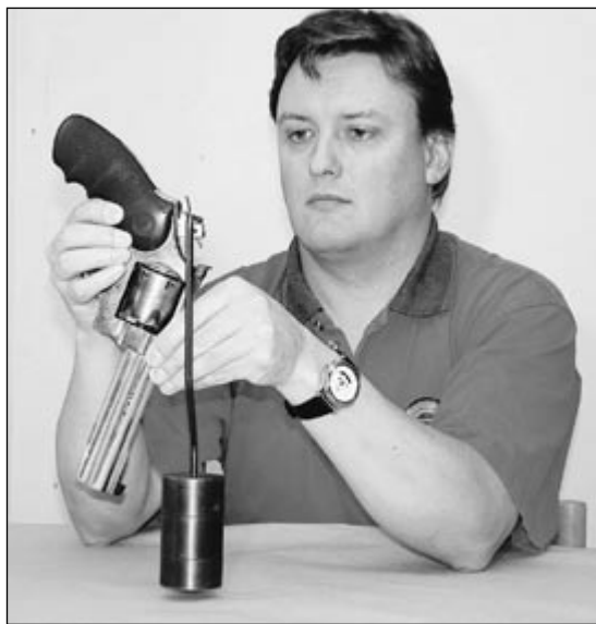
Bild 14: Kontroll av upphakningsmotstånd
